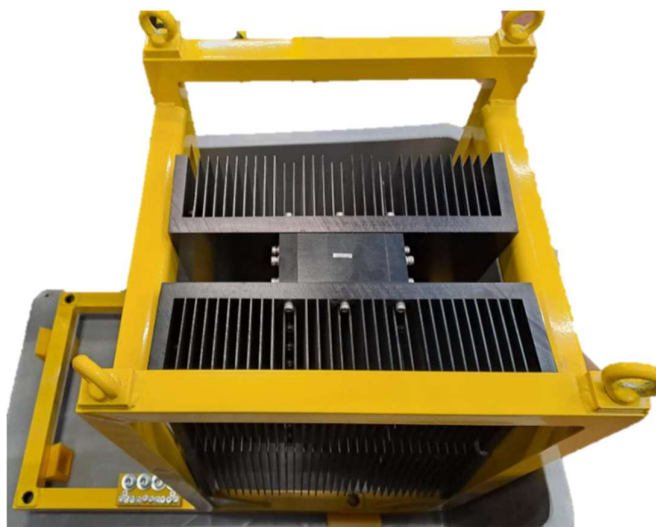
Figura 1 : Vista Superior - Carga, utilizada para testes de Aceitação do Radar Primário Banda S
