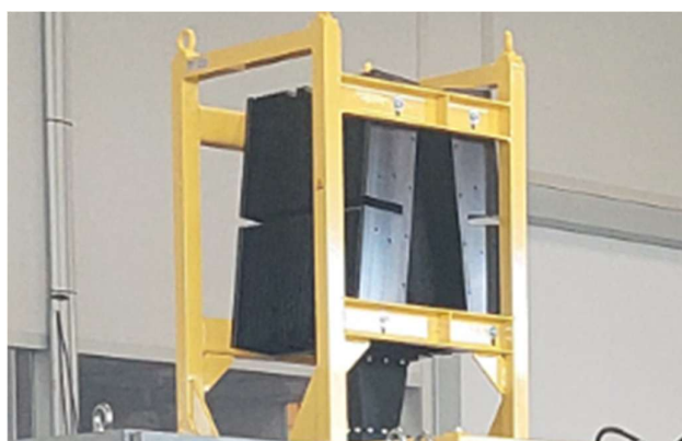
Figura 7 – SUPORTE FIXAÇÃO (AMARELO) MONTADO NA PARTE SUPERIOR DO RADAR PRIMÁRIO
